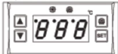
Das Gerät ist mit einer elektronischen Steuerung mit digitaler Temperaturanzeige ausgerüstet, welche sich unten in der Frontblende befindet.
