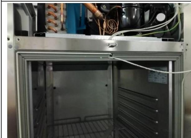
7. Das Heizelement, das der Klemme 3 R-COR entspricht, vom Klemmenbrett abtrennen.
