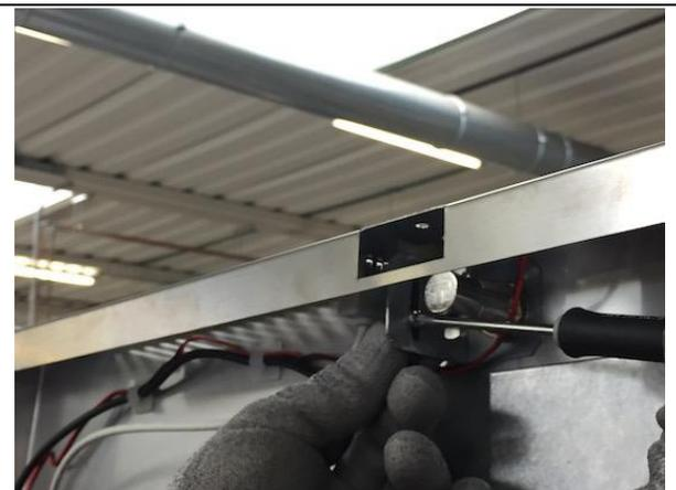
5. Den Schaltkasten wieder positionieren, dazu die Verschlusschrauben mit einem elektrischen Schraubendreher festziehen.
