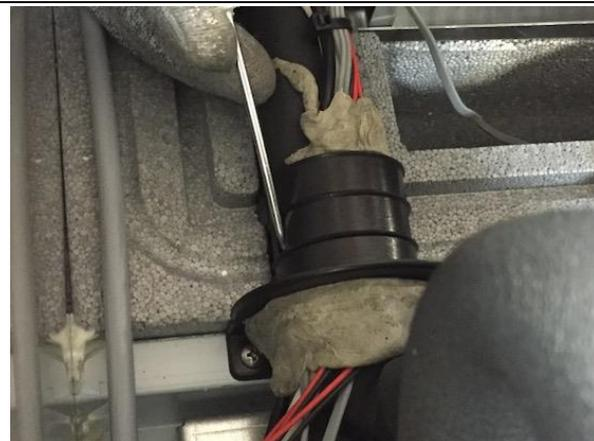
9. Die Schutzhaube des Verdampfers wieder schließen und die Sicherungsriemen korrekt fixieren.
