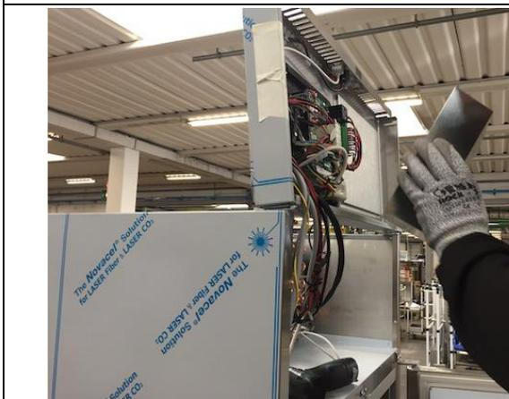
**13. Das Instrumentenbrett nach unten drehen und erneut positionieren.**
