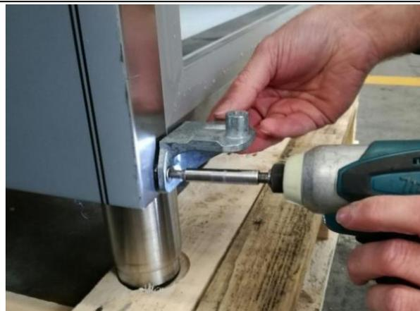
15. Die im Inneren der Tür eingesetzte Feder durch eine vollständige Umdrehung gegen den Uhrzeigersinn spannen.
