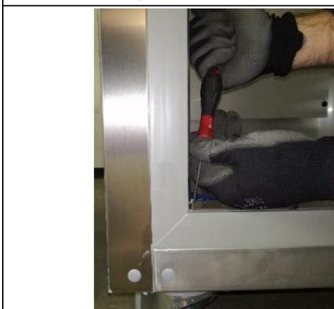
5. Das Profil entfernen und auch die weiteren Profile mithilfe eines Flachkopfschraubendrehers lösen.
