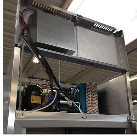
3. Den Schaltkasten entfernen, dazu die Verschlusschrauben mit einem elektrischen Schraubendreher lösen.
