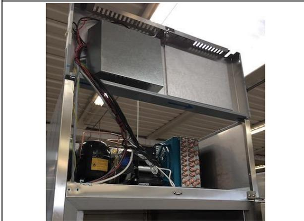
3. Den Schaltkasten entfernen, dazu die Verschlusschrauben mit einem elektrischen Schraubendreher lösen.
