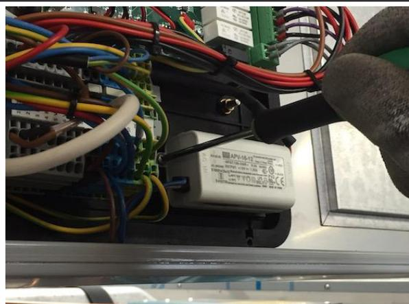
**8.** Den Transformator wieder an der Karte anschließen.
