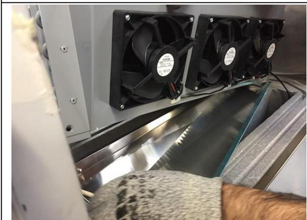
8. Das Heizelement auswechseln, dazu das Versorgungskabel herausziehen.
