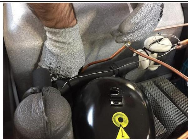
7. Den Kunststoffschutz der Kabel entfernen.
