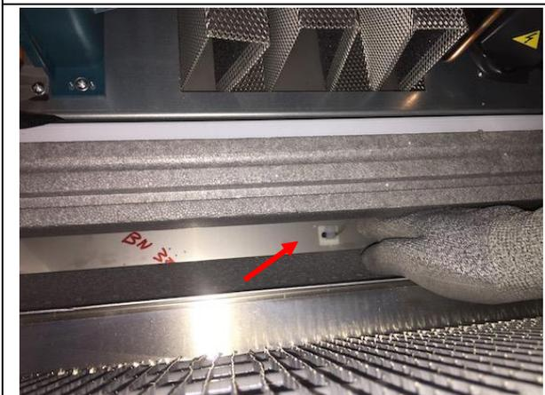
10. Den Durchgang der Kabel mit Spachtelmasse isolieren und den Schutz aus Kunststoff erneut fixieren.
