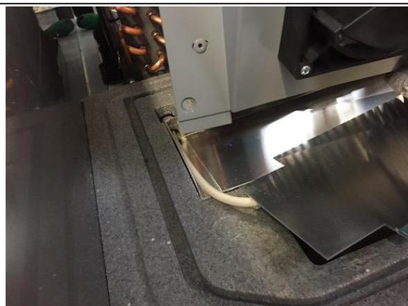
9. Den Verdampfer wieder positionieren und die Haube mit den Riemen schließen.
