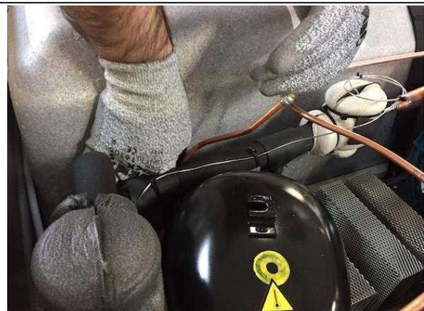
7. Den Verdampfer anheben und das Blech zusammen mit dem Heizelement herausziehen.
