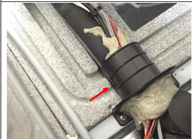
8. Die Spachtelmasse für die Versiegelung entfernen, um den Fühler zu ermitteln.
