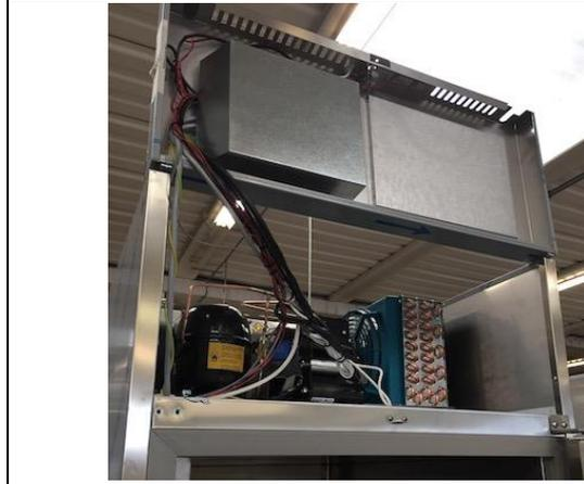
9. Den Schaltkasten entfernen, dazu die Verschlusschrauben mit einem elektrischen Schraubendreher lösen.
