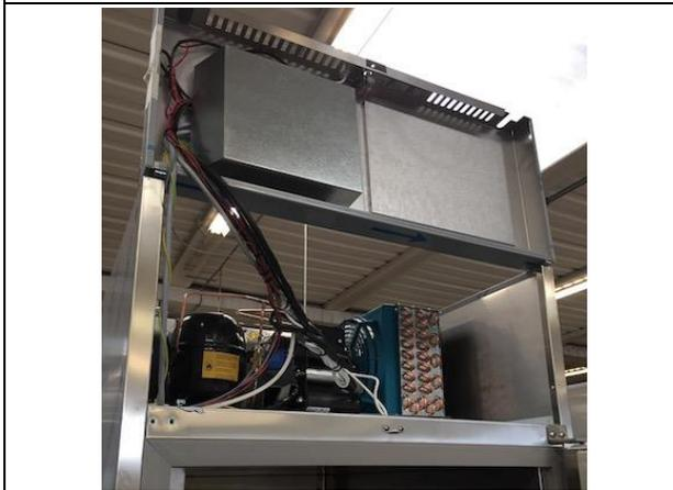
3. Den Schaltkasten entfernen und die Anschlusssteckverbinder des mit LEDBAR gekennzeichneten Türmikroschalters abtrennen.
