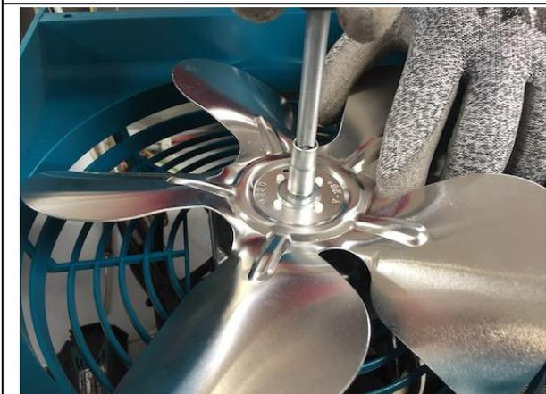
8. Das Gebläse auswechseln und wieder montieren, dabei beachten, es mit der Saugseite zu positionieren.
