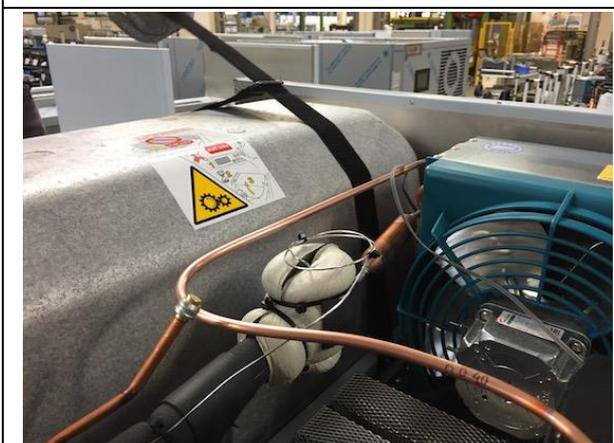
10. Die Klemme an der entsprechenden Stelle in die Klemmleiste fügen.
