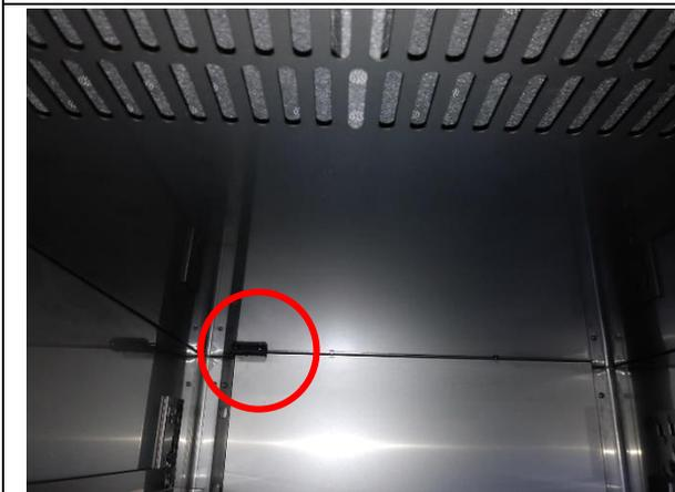
6. Um die Sonde auszuwechseln, muss der Förderer entfernt und die Sonde von unten abgeschraubt werden.
