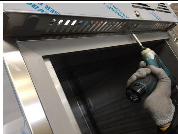
3. Die zwei Schrauben zur Befestigung des oberen Scharniers mit einem elektrischen Kreuzschlitzschraubendreher lösen.
