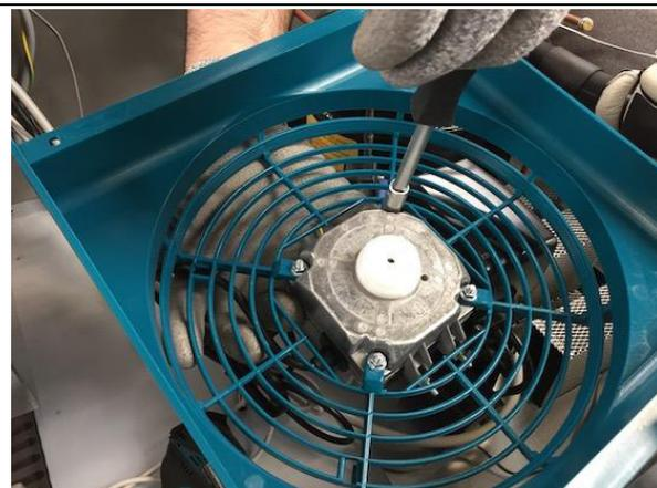
9. Den Förderer befestigen, dazu die vier Befestigungsschrauben an den Verflüssiger anschrauben.
