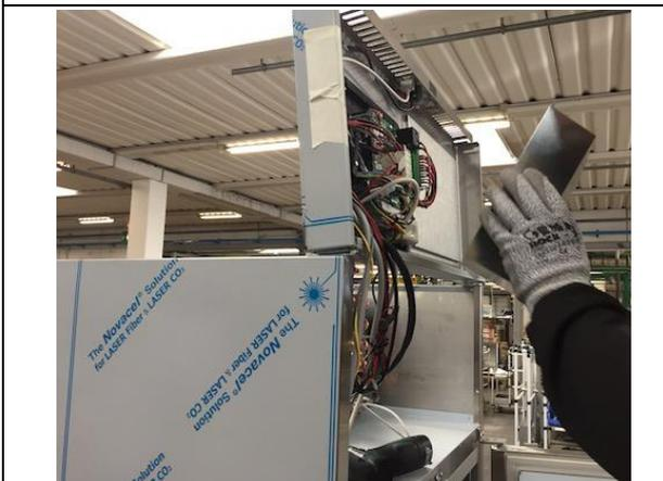
12. Das Instrumentenbrett wieder positionieren, dazu wird es nach unten gedreht und mit der dafür vorgesehenen Befestigungsschraube fixiert.
