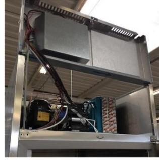
3. Das Gas mit dem entsprechenden Rekuperator zur Lagerung des Kältemittels von der Anlage entfernen.
