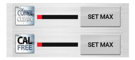
Wird die Anzeige ROT, so erinnert Sie ein Popup daran, die vorhandene Menge an Reinigungsmittel zu kontrollieren: Öffnen Sie die Tür des Geräts und die kleine Klappe unter der Garkammer und kontrollieren Sie die in der Kartusche befindliche Menge an Reinigungsmittel.
