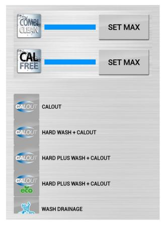
Wählen Sie **CALOUT** oder die gewünschte **Reinigung + CALOUT** aus und der Reinigungsvorgang wird gestartet.
