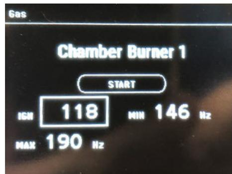
Um den Wert zu ändern, muss er durch Drehen des Drehreglers **16** markiert und durch Drücken des Drehreglers **16** bestätigt werden.
