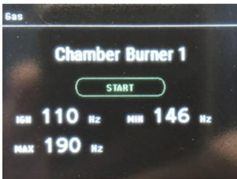
Der Brenner beginnt mit der Vorventilation, um anschließend zum Einschalten der eingegebenen IGN überzugehen. Der erste IGN-Einschaltstatus wird am Display **10** durch einen ersten Punkt unterhalb des Geschwindigkeitswertes angezeigt.
