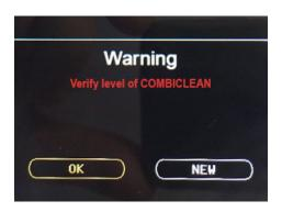
Wenn die Kartusche leer sind, diese unter Befolgung der Anleitungen im folgenden Abschnitt ersetzen, andernfalls die Meldung "OK" bestätigen, indem der Knopf **16** für das Fortsetzen der Reinigung gedrückt wird.
