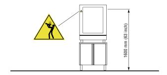
Greifen nicht auf die Maschine unter Verwendung von Systemen ein, die nicht für den Zugang zum oberen Teil geeignet sind (zum Beispiel die Verwendung von Leitern oder das Klettern auf die Maschine)
