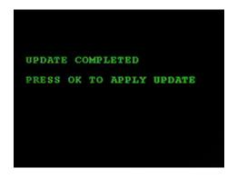
Nach Abschluss der Aktualisierung die Stromversorgung zum Ofen trennen, indem der Schalter vor dem Gerät abgeschaltet wird, ohne den USB-Stick zu entfernen. Den Ofen wieder einschalten und den Abschluss der Aktualisierung abwarten.
