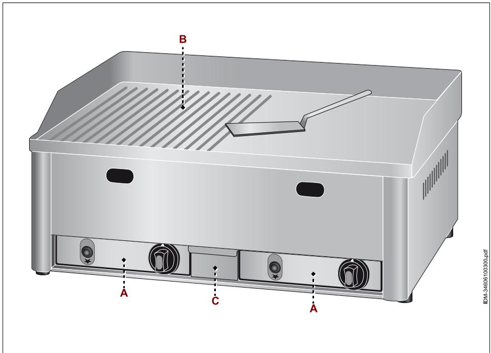
**A)** Schalttafel: mit den für das Funktionieren des Geräts notwendigen Bedienelementen ausgestattet (siehe "Beschreibung der Bedienelemente").
